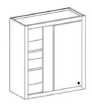
TWO SHELVES IN 30" & 36" TALL THREE SHELVES IN 42" TALL L AND R REPRESENT BLIND SIDE DOOR WILL BE HINGED TO BLIND SIDE CAN PULL UP TO 4". MINIMUM PULL 1"
